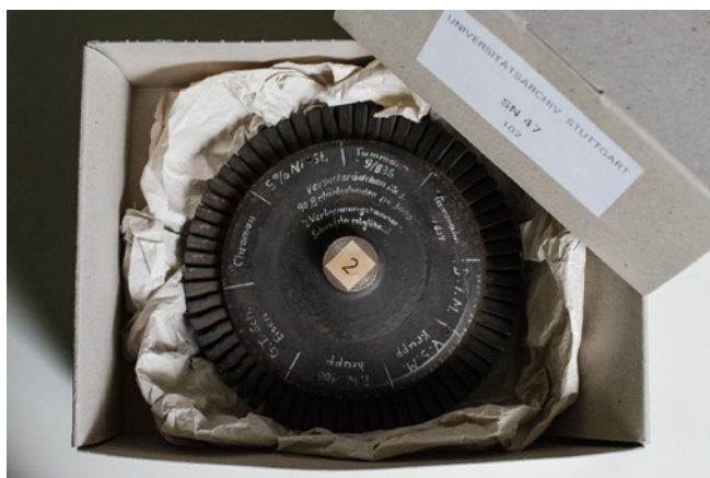
Mit solchen Versuchsrädern prüfte Hans Holzwarth die Werkstoffe für die Gasturbinenschaufeln. Nicht alle Materialproben hielten den Feuergasen von 600 bis 700 °C stand, wie auf diesem Bild die Erosion an den Schaufelkanten zeigt (Universitätsarchiv Stuttgart SN47/99).
